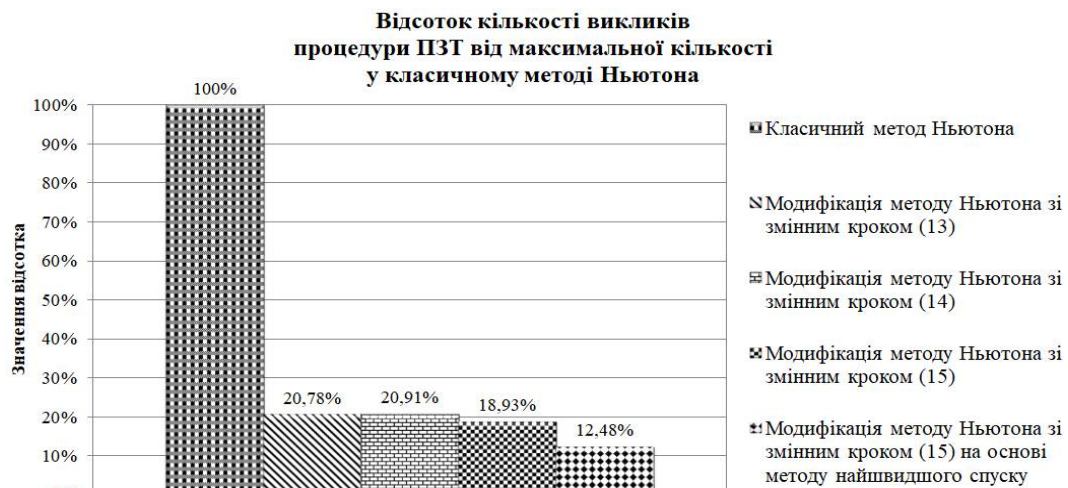
Рис. 20. Порівняльний аналіз роботи кожного методу за критерієм кількості викликів процедури розв'язку ПЗТ
