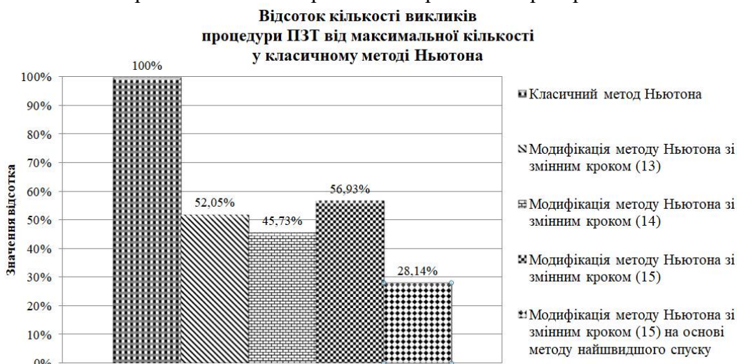
Рис. 12. Порівняльний аналіз роботи алгоритмів за критерієм кількості викликів процедури розв'язку ПЗТ з нульовим наближенням до граничної умови
