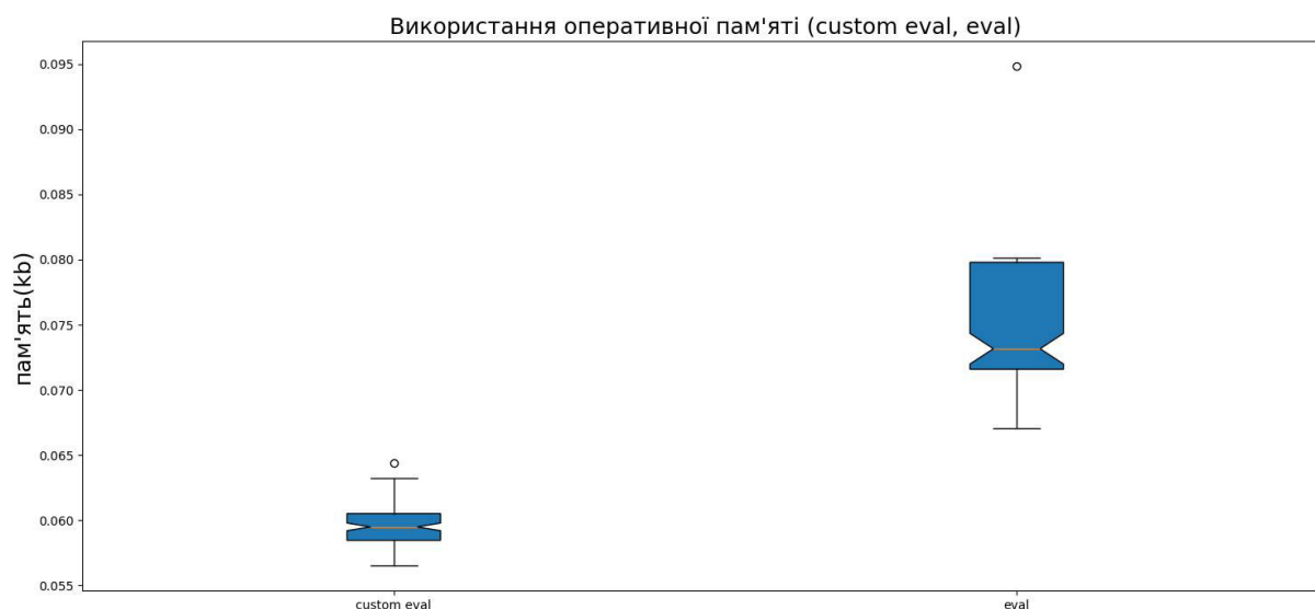
Рис. 8. Результат порівняння аналізу використання оперативної пам'яті при генерації алгебраїчних рівностей CUSTOM_EVAL і EVAL
