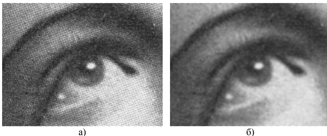
Рис. 2. Робота фільтру Гаусового розмиття: а) початкове зображення; б) розмите зображення
